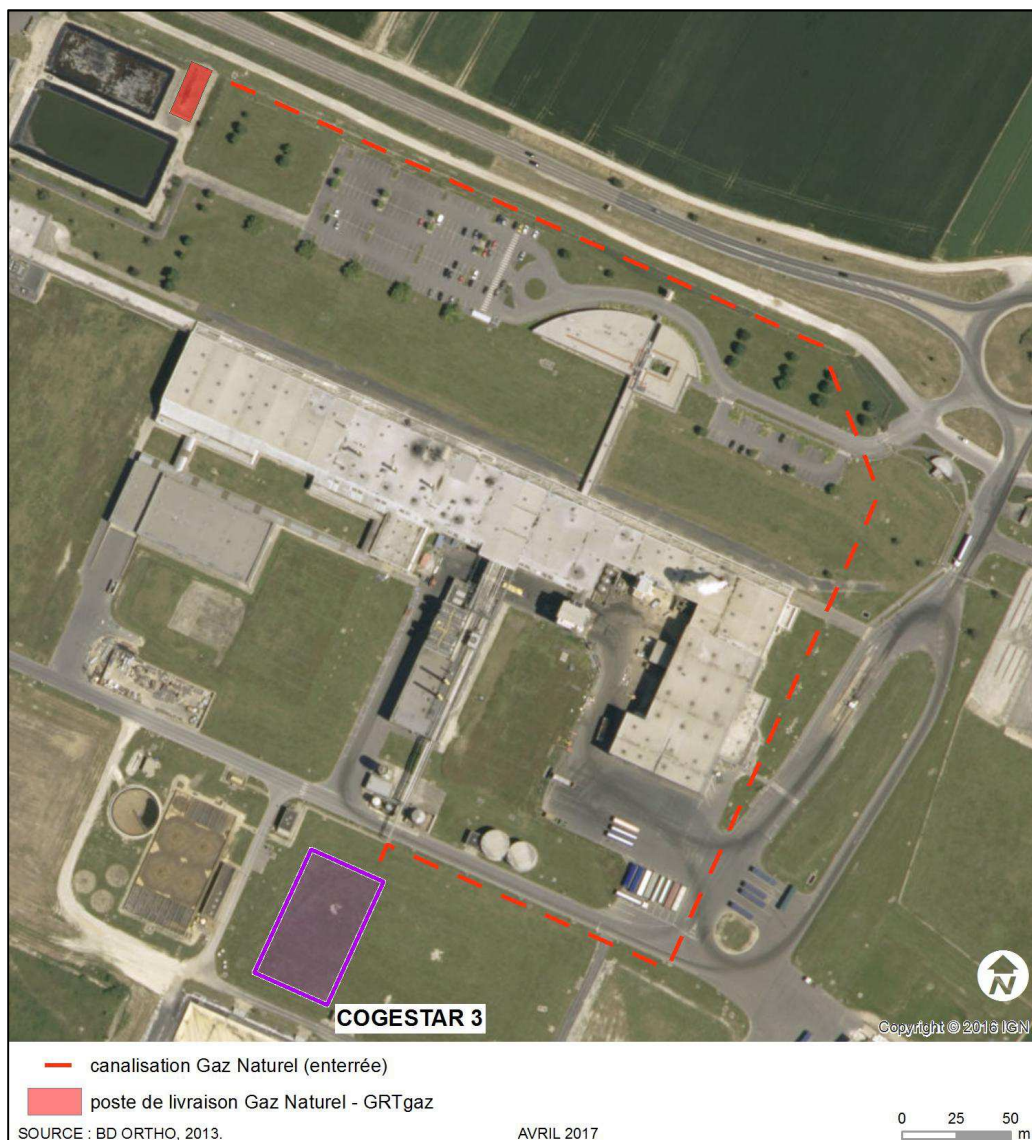
Illustration n° 1 : Tracé de la canalisation de gaz naturel
